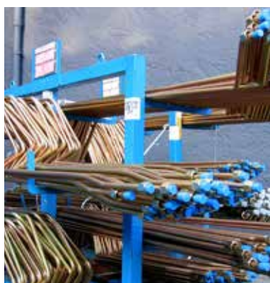
tuyauterie hydraulique 7 cintres avec raccords
