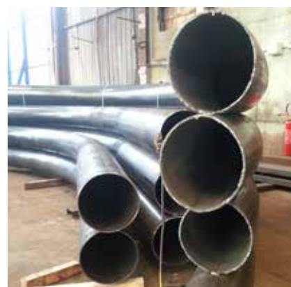
tube Ø273 ép 6 entrée tunnel TGV
