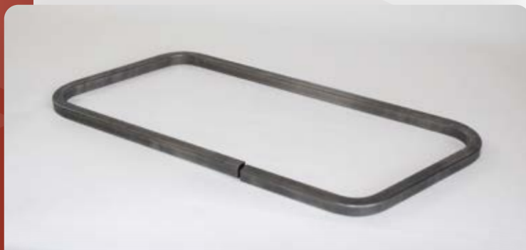
Tube carré cintré 20x20x2 rayon 50mm à l'axe
