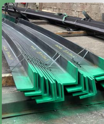
cintrage de cornières égales et inégales
